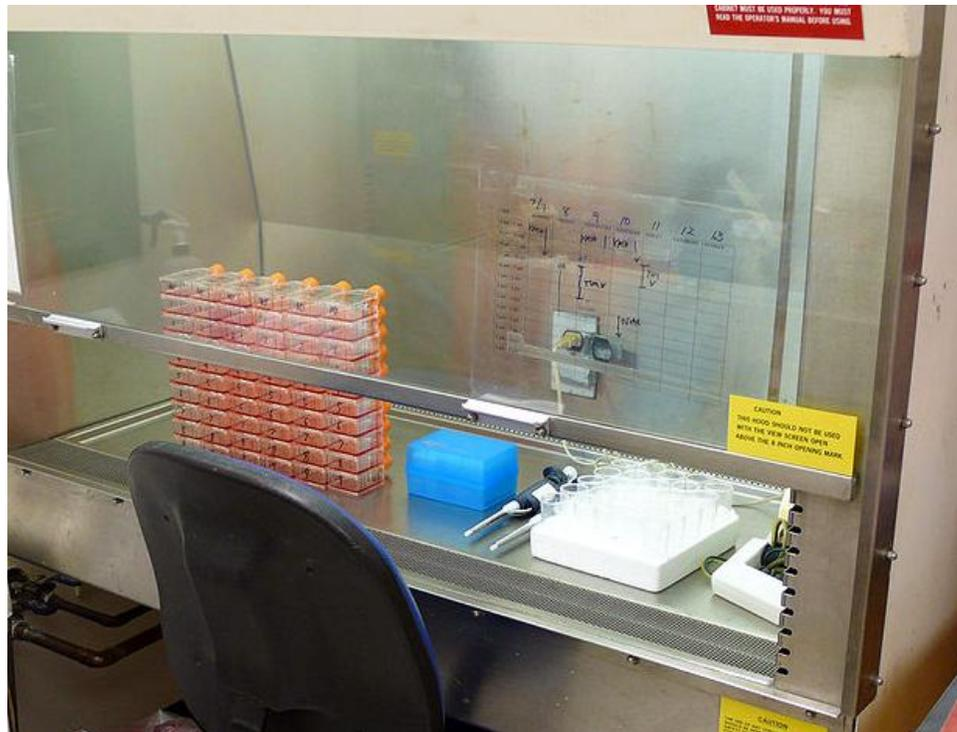
**Figure 6** : Enceinte de sécurité biologique pour la manipulation de microorganismes pathogènes du groupe 2. La circulation de l'air dans ce type de hotte est conçue afin de créer un « rideau d'air » (flux laminaire) stérile entre l'extérieur et l'intérieur de la hotte qui limite les échanges gazeux entre les deux. Par ailleurs, l'air à l'intérieur de la hotte est filtré lorsqu'il entre et lorsqu'il sort, afin d'empêcher toute contamination. (SOURCE : Wikimedia Commons)
